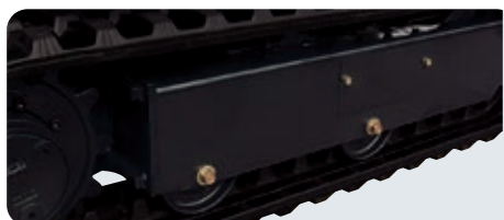
走行振動をやわらげる外ツバ式トラックローラー
