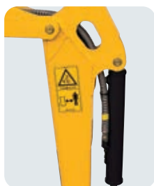
バケットシリンダーホースのアーム内装化
